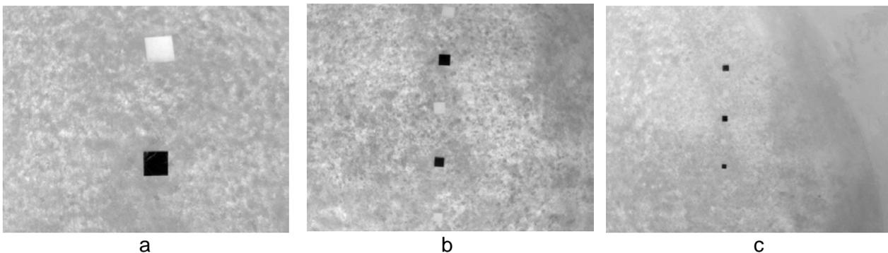
Figure 6.3. a)  $h = 2\text{ m}$ , markers  $15 \times 15\text{ cm}$ , b)  $h = 6\text{ m}$ , markers  $15 \times 15\text{ cm}$ ,  $10 \times 10\text{ cm}$ , c)  $h = 10\text{ m}$ , markers  $15 \times 15\text{ cm}$ ,  $10 \times 10\text{ cm}$ ,  $5 \times 5\text{ cm}$
